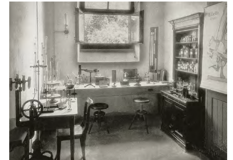
Medizinisches Laboratorium um 1910 im Klinikum von Bircher-Benner („Bircher-Müslis“ als Ernährungstherapie). Von links nach rechts: Zentrifuge, Pipette, Wasserbad, Zucker-Polarimeter und Mikroskop.
