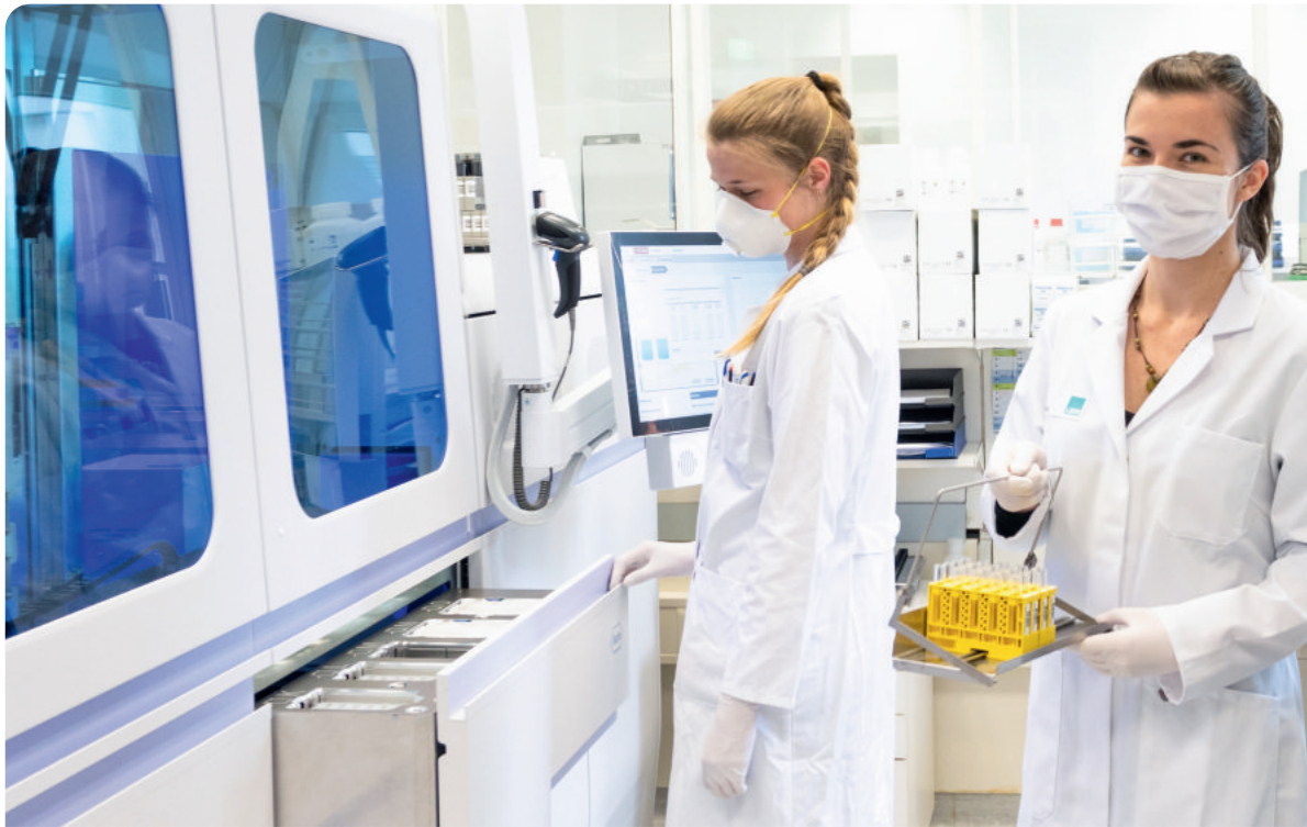
Bei Corona-Tests im Labor startet ein Lauf in dem PCR-Vollautomaten Cobas 8800 mit 96 Proben, bis zum Ergebnis dauert es etwa drei Stunden. Am Tag schafft ein Gerät rund 1500 Analysen. Foto: LADR
